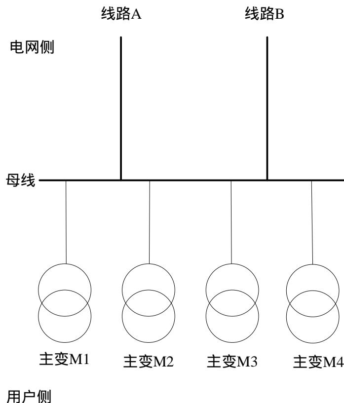
当存在电网功率从 A 线路穿越 B 线路时，线路 A 的需量曲线（为正）加上线路 B 的需量曲线（为负），得到扣除穿越功率的线路 A 需量曲线。该需量曲线与不存在穿越情况下的线路 A 的需量曲线相比，最大值即为线路 A 的最大需量。
