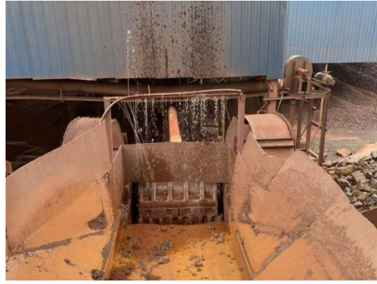
项目破碎点喷水降尘
