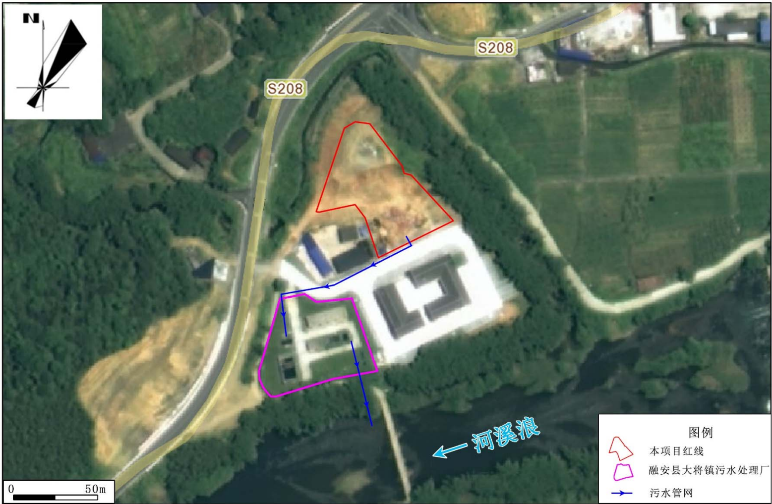
附图6 项目污水排水走向示意图
