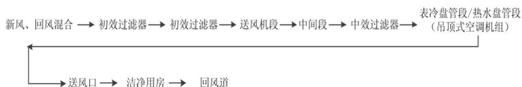
图 2-3 洁净空调系统原理图
